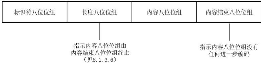
图 2 一种替换的结构化编码
